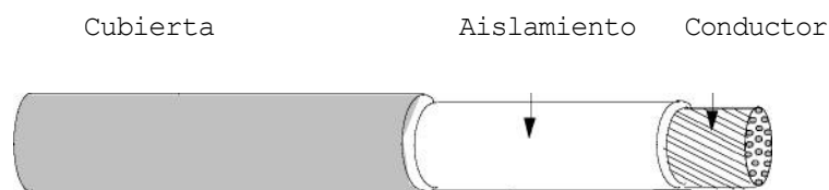
Fig. 1: Constitución del cable
