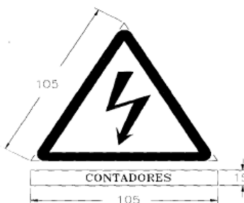
Figura 3 – Señal de Contadores
