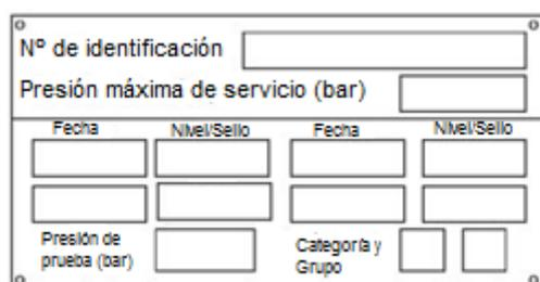
La placa podrá ser adhesiva y tendrá unas dimensiones de 70 x 35 mm.
