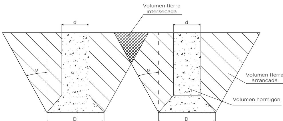
La comprobación a compresión de la zapata se realiza calculando todas las cargas que actúan sobre la base de la zapata y que son:
