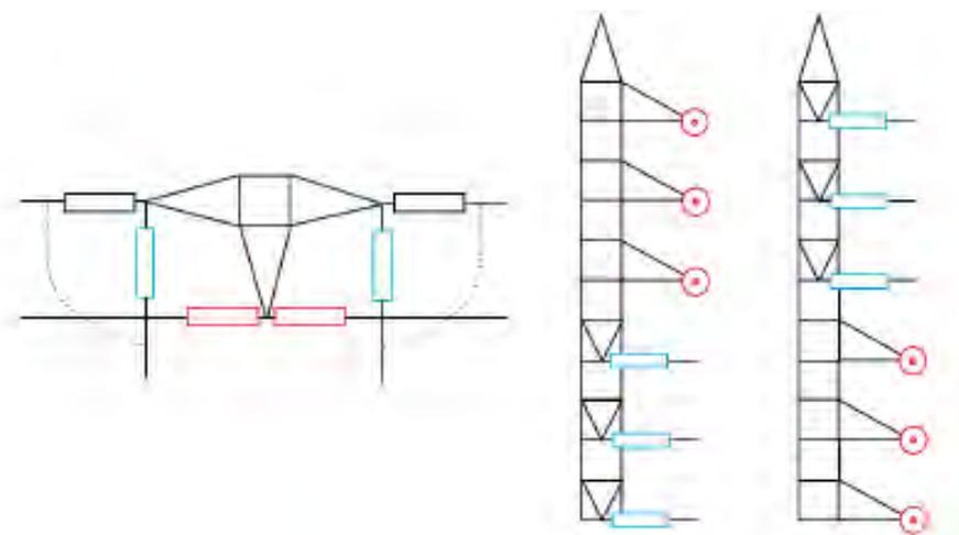
**Fig 3 Esquema entronque doble circuito en el lado lejano a la derivación**
