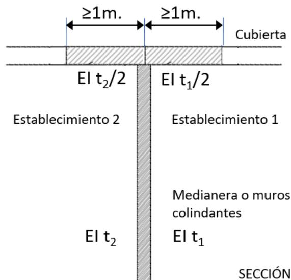
Figura 2.12: Compartimentación en cubierta entre dos establecimientos.
