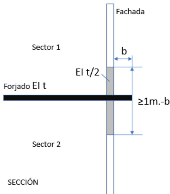
Figura 2.10: Compartimentación vertical con saliente horizontal en fachada.
