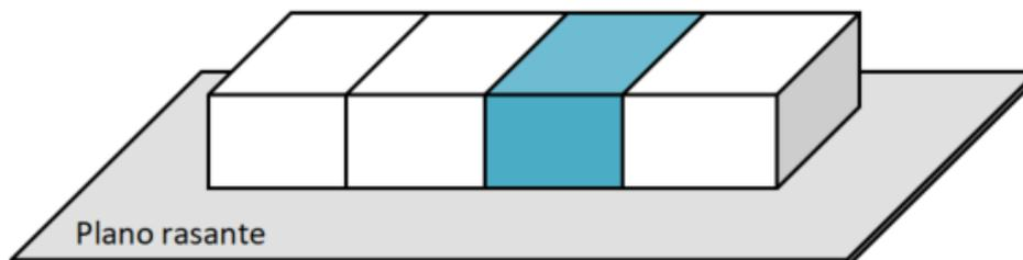
Figura 1.2: Configuración tipo A<sub>H</sub> (estructura común con otros establecimientos, separados en horizontal).
